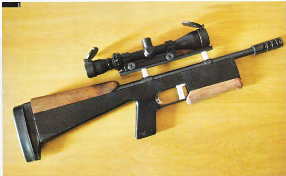
Foto 1. Il Kurzrifle è lungo appena 60 centimetri, ma di questi ben 57,5 sono occupati dalla lunghezza della canna. Di fronte al grilletto, sempre all'interno del ponticello, è posta la leva di caricamento dello scatto.
