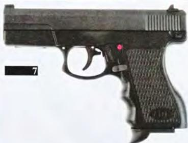
l'arretramento del carrello provoca la compressione della camera formata dal cilindro scorrevole (all'esterno) e dal corpo della canna (all'interno), con i suoi risalti anulari che fungono da guarnizione di tenuta; all'interno di questa camera, però, si scarica una parte dei gas prodotti dalla combustione della carica di lancio. L'espansione di questi gas contrasta la naturale compressione che avverrebbe all'interno della camera e ciò frena il movimento retrogrado di rinculo del carrello.
